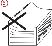
Papier zu dünn, Klammerung trägt auf
